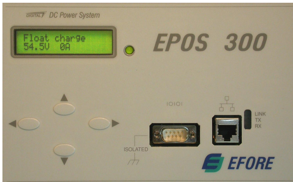
Рисунок 1 ЖК монитор, кнопки, RS-232 и разъемы Ethernet
