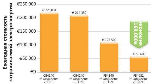
**Чиллер Liebert® HPC с естественным охлаждением и системой SmartAisle™ в сравнении со стандартной установкой**
