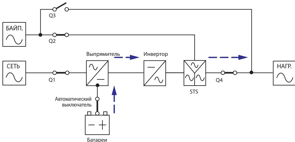
Рис. 3-2. Автономный режим работы, система с одним ИБП
