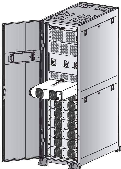
Рис. 7-4.: Установка силового модуля
