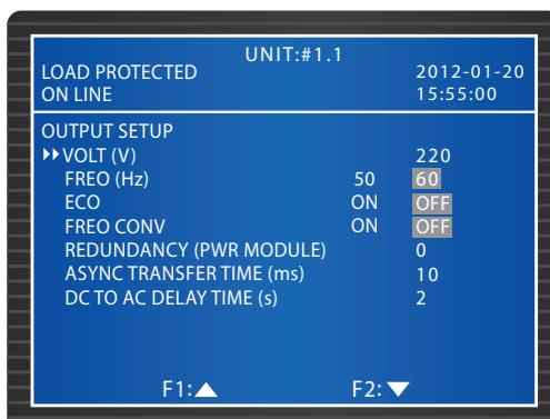
На этом экране можно задать следующие параметры. Выходное напряжение (**НАПРЯЖЕНИЕ(В)**) и частоту (**ЧАСТОТА (Гц)**). Если активирован экономичный режим **ЭКО**, т.е. напряжение байпаса на входе байпаса не отклоняется более чем на ±10 % от номинального, а входная частота не отклоняется от номинальной более чем на ±5 Гц, то ИБП переходит в режим байпаса; в противном случае ИБП переключается в нормальный режим.
