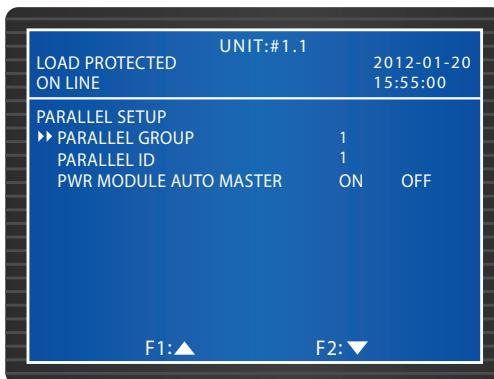
Для параллельного соединения ИБП следует настроить пункты ПАРАЛЛЕЛЬНАЯ ГРУППА и ID ПАРАЛЛЕЛИ.
