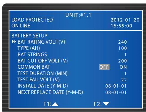
Если к ИБП подключены внешние батарейные кабинеты, то на показанном выше экране можно задать следующие параметры.
