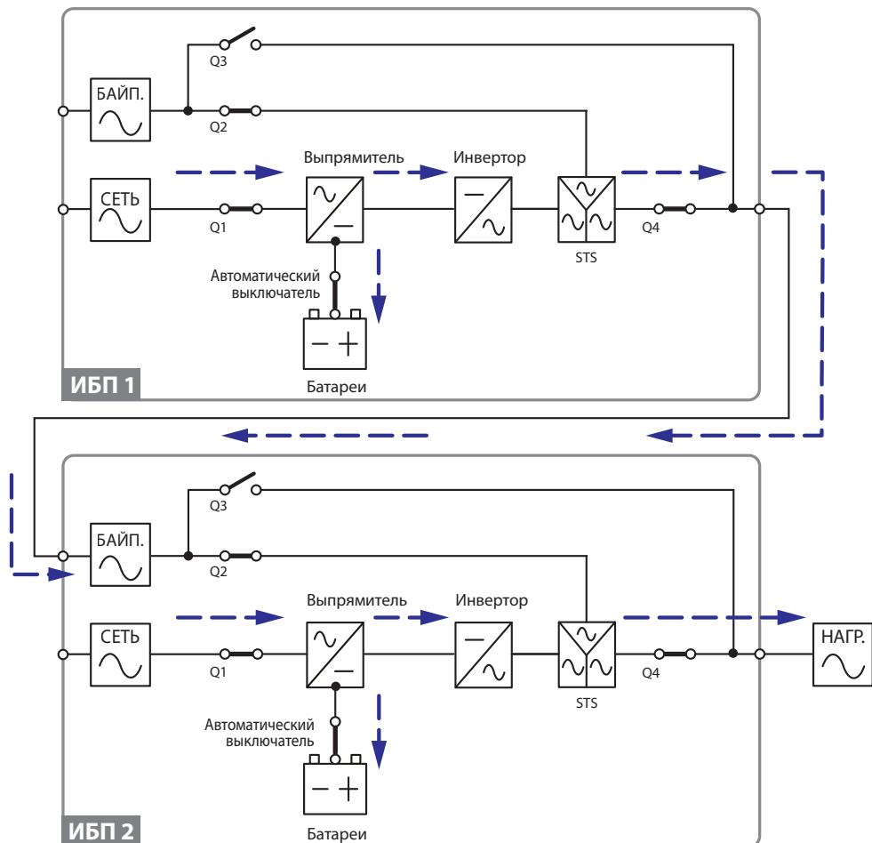
*Рис. 3-10. Последовательное резервирование*
