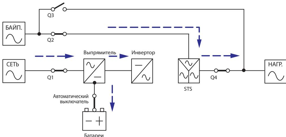
Рис. 3-5. Экономичный режим (ECO) , система с одним ИБП
