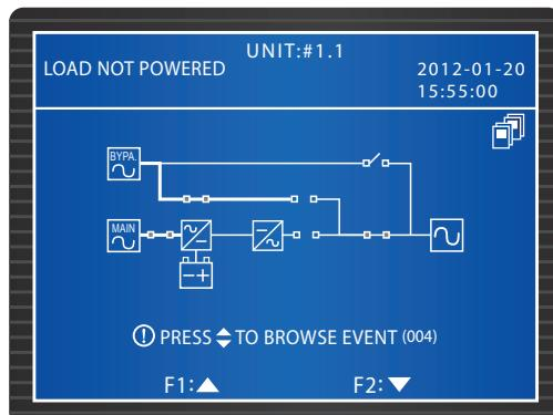
ЖК-дисплеи на остальных параллельных ИБП будут выглядеть так:
