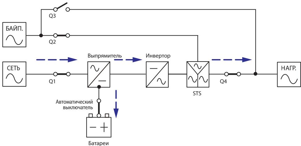
*Рис. 3-1. Нормальный режим работы, система с одним ИБП*
