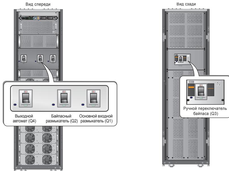
*Рис. 2-9. Вид спереди: выходной автомат, байпасный размыкатель и основной входной входной размыкатель*
