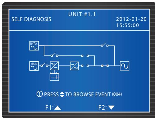
4. ИБП в режиме байпаса. Сетевой вход и батареи отключены. Нагрузки не защищены. При исчезновении переменного напряжения на входе байпаса они будут обесточены.
