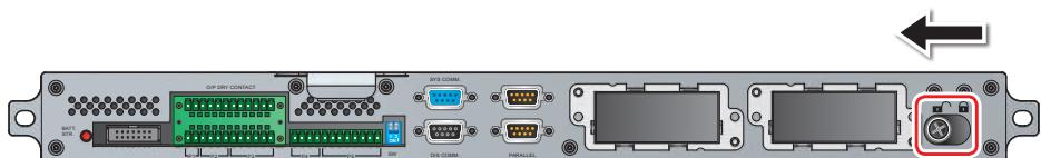
Рис. 7-15. Разблокировка защёлки
