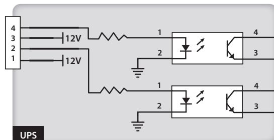
Рис. 4-6. Входы с сухими контактами (два комплекта)
