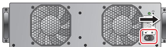
Рис. 7-6. Блокировка защёлки
