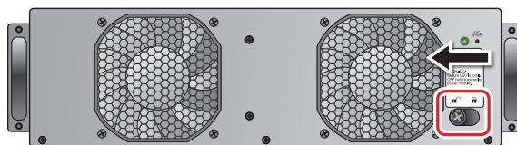
Рис. 7-7. Разблокировка защёлки
