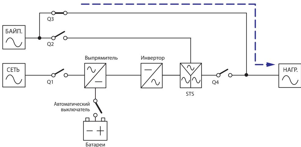
Рис. 3-4. Режим ручного байпаса, система с одним ИБП
