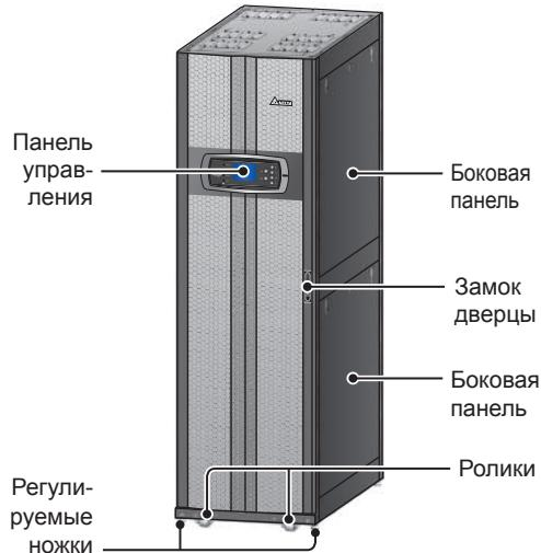
Рис. 2-1. Внешнее устройство ИБП
