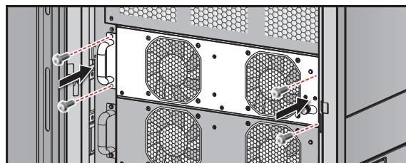
Рис. 7-5. Фиксация винтами
