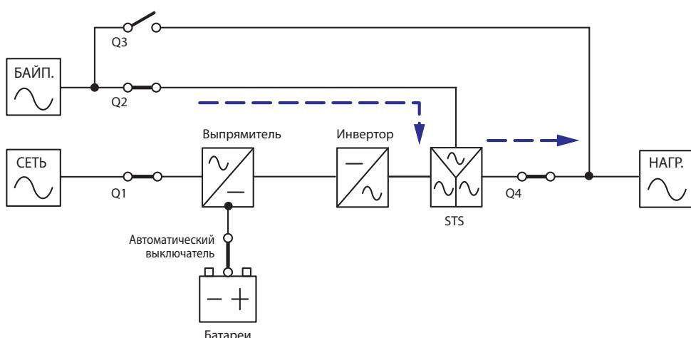
Рис. 3-3. Режим байпаса, система с одним ИБП
