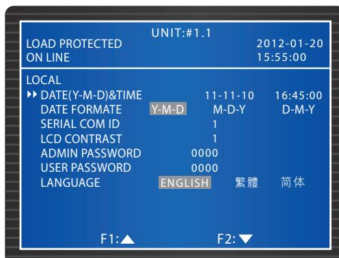
На этом экране можно задать внутренние настройки. Если ИБП соединены параллельно, то для каждого ИБП можно задать **ID ПОСЛЕД. ПОРТА**.
