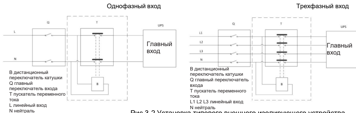
Рис.3-2 Установка типового внешнего изолирующего устройства
