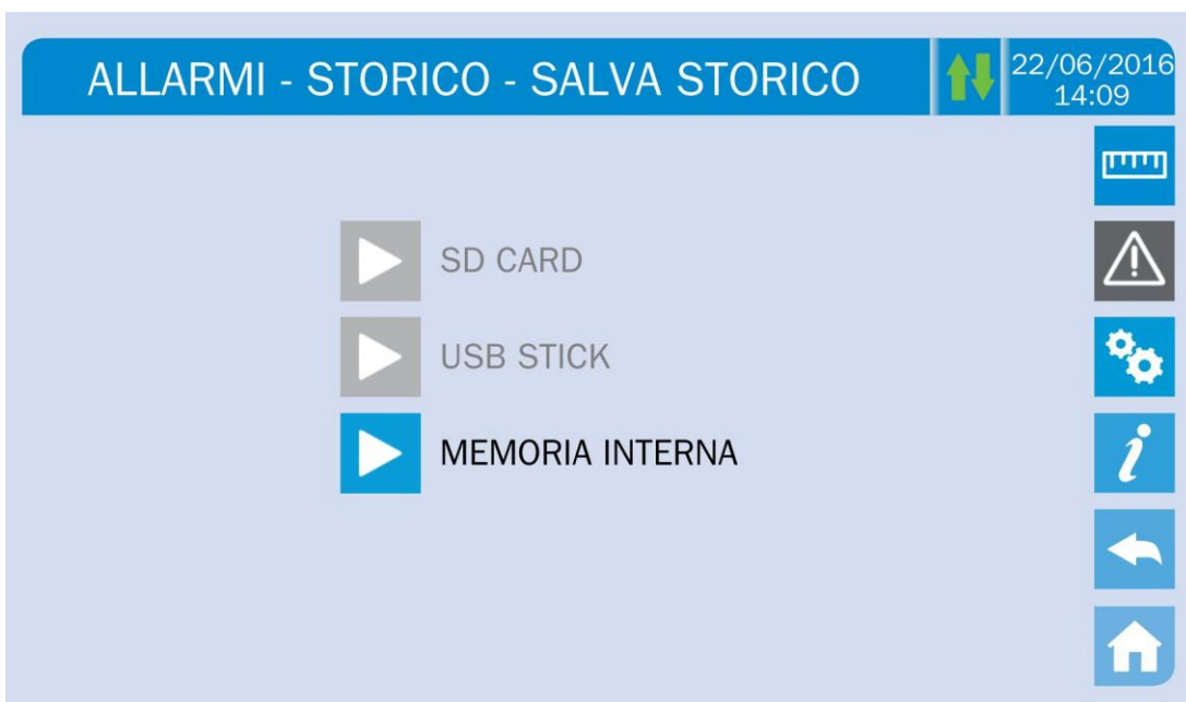
Figura 15 – Storico allarmi, salvataggio file
